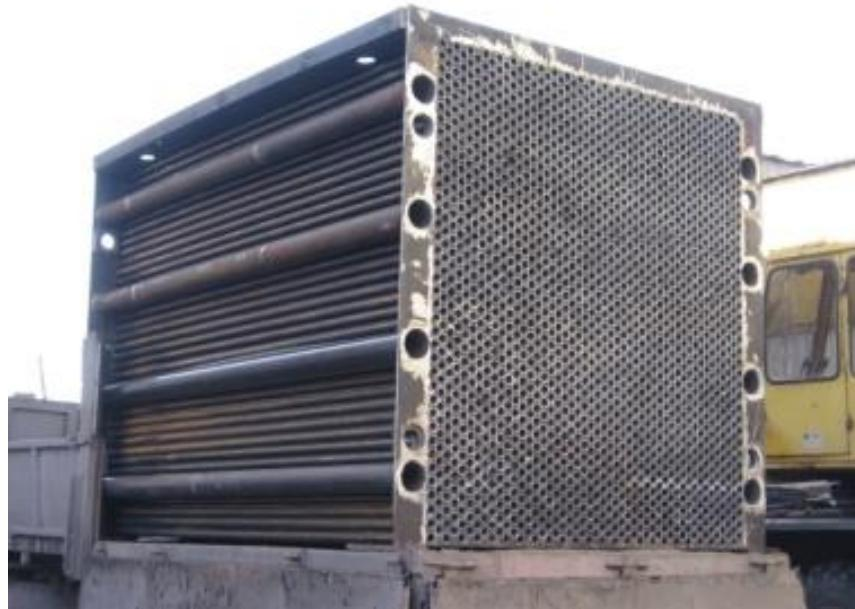
Воздухоподогреватели предназначены для подогрева воздуха, подаваемого в топки паровых котлов для горения топлива. Подогрев воздуха в воздухоподогревателях производится до температуры 150 – 250 гр. С за счет тепла уходящих из котла газов. Применение воздухоподогревателей в котлоагрегатах позволяет повысить коэффициент полезного действия котлов за счет снижения температуры уходящих газов и интерсифицировать процесс горения топлива.
