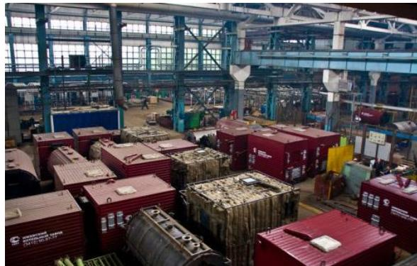
Котлы водогрейные серии КВм выпускаются производительностью от 0,6 до 4,0 МВт и температурой воды на выходе из котла до 95°C.
