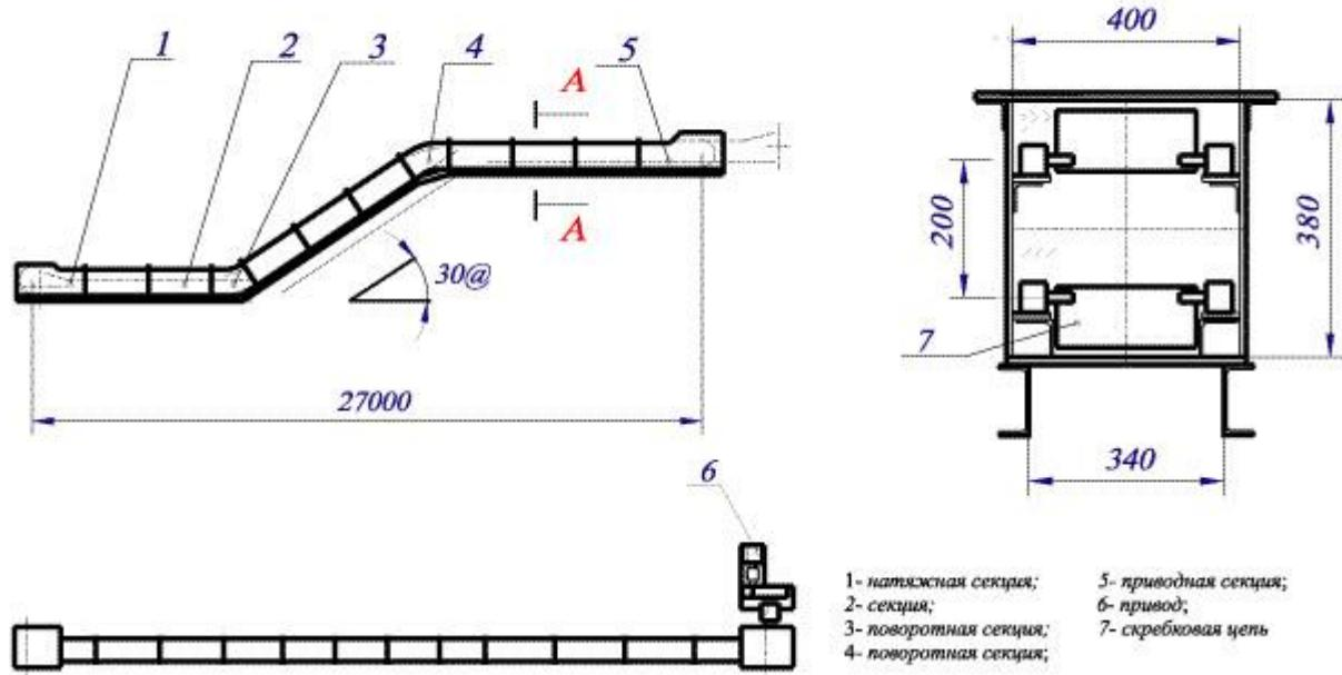
Транспортер скребковый ТС-2-30 с двумя тяговыми цепями предназначен для удаления шлака и золы и подачи угля в котельную.
