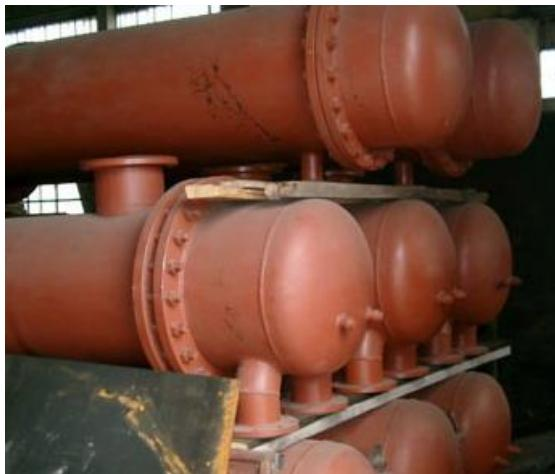
Предназначены для систем отопления и горячего водоснабжения. Подогреватели состоят из п количества секций длиной L=2, 3 и 4 м, диаметром d=57...530 мм.
