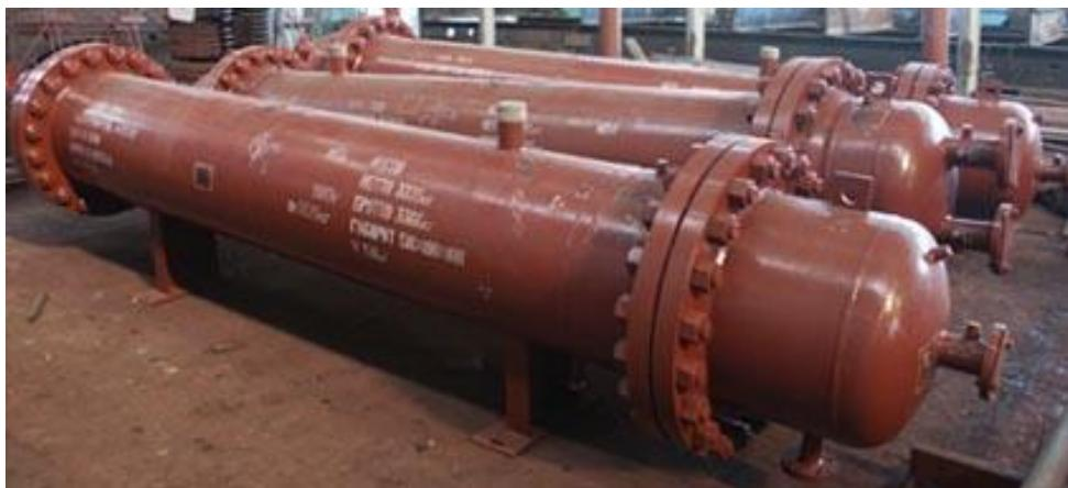
**Подогреватели пароводяные типа ПП** предназначены для подогрева воды, поступающей на химводоочистку в отопительных, отопительно-производственных и производственных котельных. Представляет собой аппарат горизонтального типа, с неподвижными трубными решетками. Состоит из трубной системы, передней и задней крышек, арматуры и КИП.
