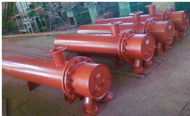
Общая поверхность нагрева определяется путем умножения количества секций (n) на поверхность нагрева одной секции.
