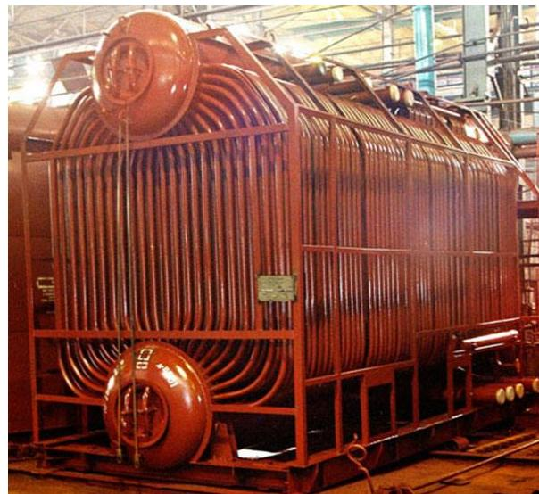
**Каждый котел типа КЕ** паропроизводительностью от 2,5 до 10 т/ч оснащен контрольно-измерительными приборами и арматурой, оборудованы двумя предохранительными клапанами.
