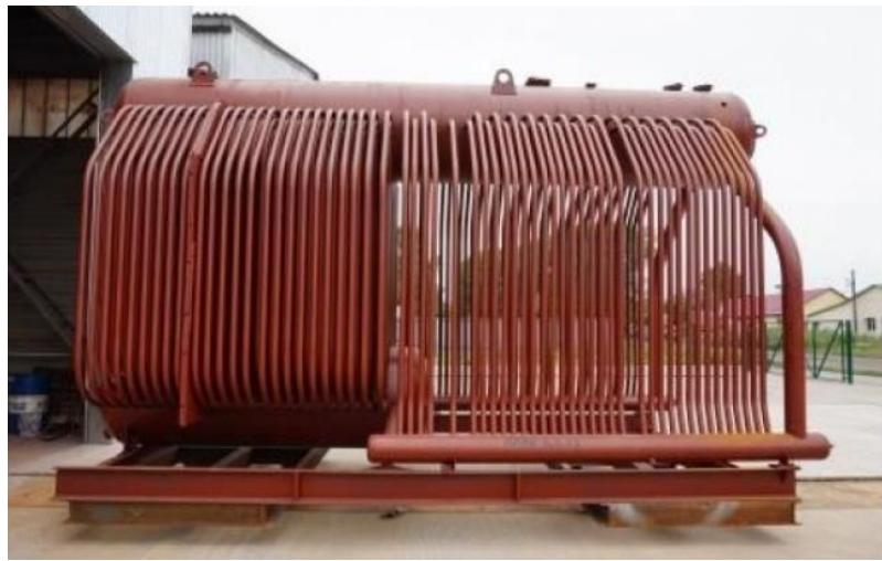
**Котлы паровые серии ДКВр** - это двухбарабанные, вертикально-водотрубные котлы с естественной циркуляцией предназначены для выработки насыщенного или перегретого пара, идущего на технологические нужды промышленных предприятий, в системы отопления, вентиляции и горячего водоснабжения. Естественная циркуляция образуется в замкнутом контуре за счёт разности плотностей смеси в опускных и подъёмных трубах. Котлы данной серии имеют возможность перевода в водогрейный режим.
