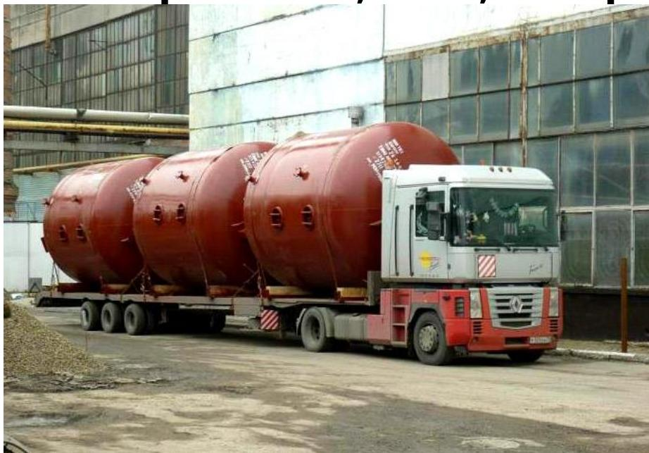
**Осветительный фильтр (ФОВ)** - это вертикальный цилиндрический аппарат насыпного типа действия, предназначен для очищения воды от примесей разной степени дисперсности. Широко используется в технологических схемах водоснабжения, в процессе водоподготовки электростанций, отопительных и промышленных котельных.
